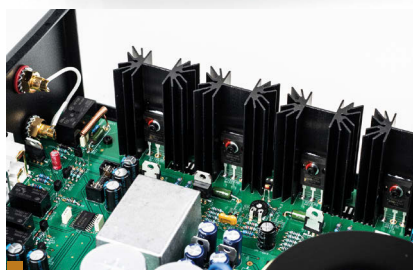
Stopnie końcowe są identyczne, jak we wspomnianej integrze - tworzą je cztery tranzystory MOSFET IRFP9140N.
