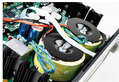
Zasilacz dual-mono na bazie dwóch, 340-VA toroidów i ośmiu kondensatorów 6800 µF także pochodzą z IN200 Signature.
